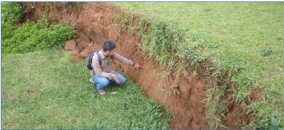
Gambar 4. Profil tanah di bagian atas berupa material urugan setebal 50 cm, dibagian bawah berupa lapukan batuan atau soil setebal lebih dari 4 meter.
