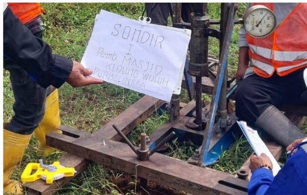
Gambar 10. Pengujian Daya Dukung Tanah dan Kedalaman Tanah Keras Menggunakan Sondir
